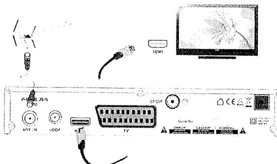
Pokud vlastníte zesilovač se vstupem a výstupem HDMI, který podporuje přenášení zvuku přes HDMI, zapojte jej pomocí dvou HDMI kabelů. Stejně jako na následujícím obrázku: jeden kabel zapojte do zesilovače a druhým propojte zesilovač s televizí.
