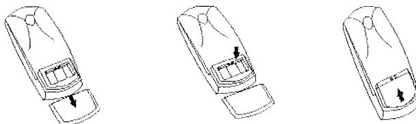
Sejměte kryt příhrádky na baterie na zadní straně dálkového ovladače jeho vysunutím směrem dolů a odložte jej. Vložte dvě baterie AAA (R03) dovnitř příhrádky tak, aby poloha pólu + a - odpovídaly zobrazeným symbolům. **Nekombinujte staré baterie s novými ani různé typy baterií.** Nasadte kryt příhrádky na baterie a zasuňte jej, až zapadne.
