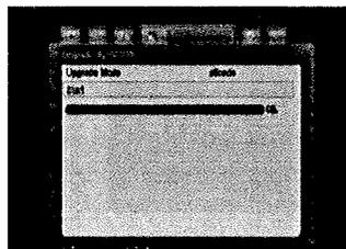
Toto menu umožňuje přenést software, nastavení nebo seznam kanálů z jednoho přijímače na druhý stejného typu. Propojte přijímače kabelem RS232 Null Modem. Pro přenesení celého softwaru zvolte **allcode**, pro přenesení pouze aktuálního nastavení a seznamu kanálů zvolte **userdb**.
