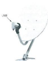
LNB (Low Noise Block konvertor) slouží k zesílení a převodu vysokých frekvencí vysílaných z družice na několikanásobně nižší frekvence, které nazýváme Střední pásmo (IF).
